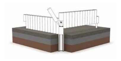
Einfundamentierung der Beeteinfasssung mit Hilfe von verlängerten Montagerohren auf losem Untergrund. Eine Verklebung der Elemente untereinander ist erforderlich.
